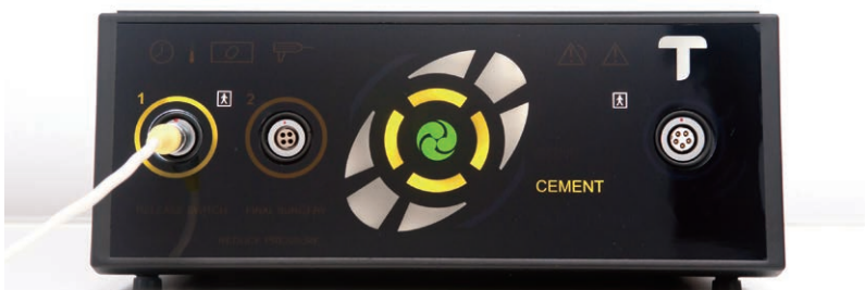
図 11 チャンネル 1、セメントトランスデューサーが作動状態
